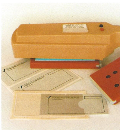
Löschung Die Löschung der EPROM-Kassetten ist einfach und in der Handhabung problemlos. Durch Entfernen der Beschriftungs-Etiketten bzw. -Taschen werden Löcher in der Kasette freigelegt, durch die eine Bestrahlung mit UV-Licht erfolgen kann. Die Löschung der EAROM-Kassetten geschieht elektrisch bei eingebauter Kasette.
