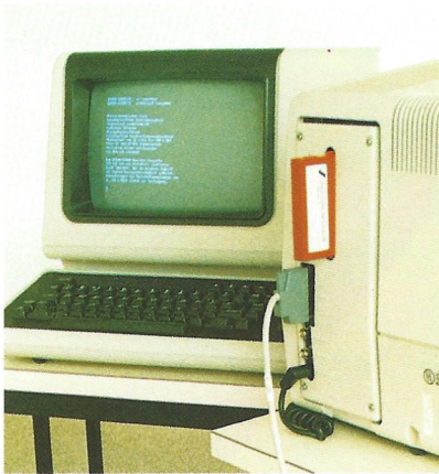
Bildschirmterminal als Programmierstation Eingebaut im intelligenten Bildschirmterminal kann die Programmierung von Kassetten Hand in Hand mit den modernen Möglichkeiten zur Erstellung von Werkstückdaten, Steuerungsabläufen usw. vorgenommen werden.
