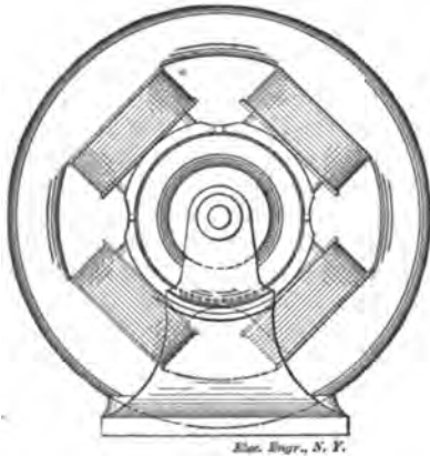
FIG. 10.—FIFTY-FOUR KILOWATT "A. E. G." DYNAMO.
